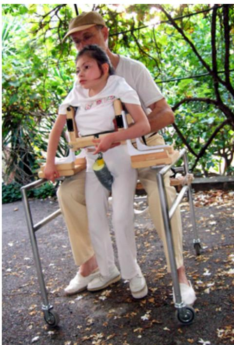
Imagen de uso de las muletas con el asistente colocado detrás y apoyado en la estructura de las propias muletas.
